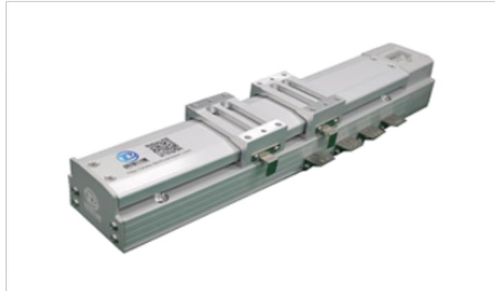
直线滑台模组与电机控制直线滑台模组的基本分类1. 1按工作原理分类按工作原理对直线滑台模组进行分类，可分为两大类：丝杆传动和同步带传动。丝杆传动通过联轴器将伺服电机和滚珠丝杆连接在一起，进而将伺服器的旋转运动转化为直线运动。丝杆模组定位精度高，推力大。同步带传动通过同步轮和同步带取代丝杆和螺母，伺服电机带动同步轮转动，使同步带做直线运动。相比于丝杆模组，同步带模组虽然没有了定位精度和推力，但实现了高速度。由此可见，丝杆模组更高精度，而同步带模组则着更快的速度。微型滑台的精度可以达到多少？无锡HIWIN滑台在哪买
