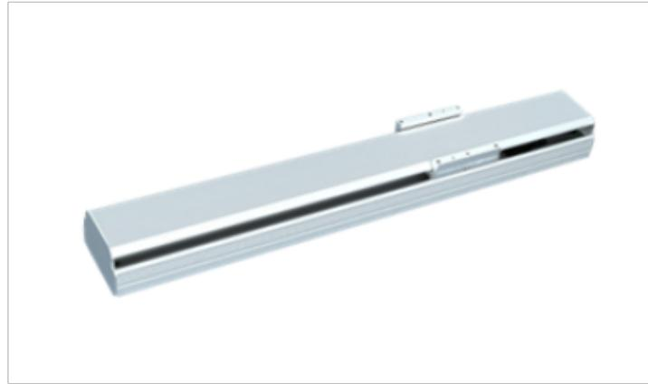
随着工业化的进程，机器人逐渐进入了人们的视线，而在工业中，机器人通常以机械手的形式出现。结合各种实际需求，机械手有大到数米，小的十几厘米、柔性的、大负载的，各种类型层出不穷。而在普通常规的应用中，我们常常听到滑台模组或者单轴机械手这个东西。在电子行业，我们把结构、性能上独力一种组件叫做模组。而在机械行业，我们同样把一种机械结构叫做模组，为了方便区分，我们通常叫它滑台模组或者定位滑台。那么它到底是什么东西呢？滑台模组是干什么用的呢？如图就是一台简单的滑台模组。为了获得一定区间内的自动高精度定位功能，满足实际生产中的点对点运动需要，工业上发明了这样一种用各种配件如直线导轨、滚珠丝杆、滑动座等组合起来的一种整体模组式的滑台，它可以单轴使用配合必要的夹具、量具或者作业工具实现特定功能，如CCD检测、PCB涂胶、电路板焊锡等。当然，复杂一点的作业也可以通过将多台单轴滑台模组组合来完成，以多轴组合的方式来获得更大的自动工作范围。
